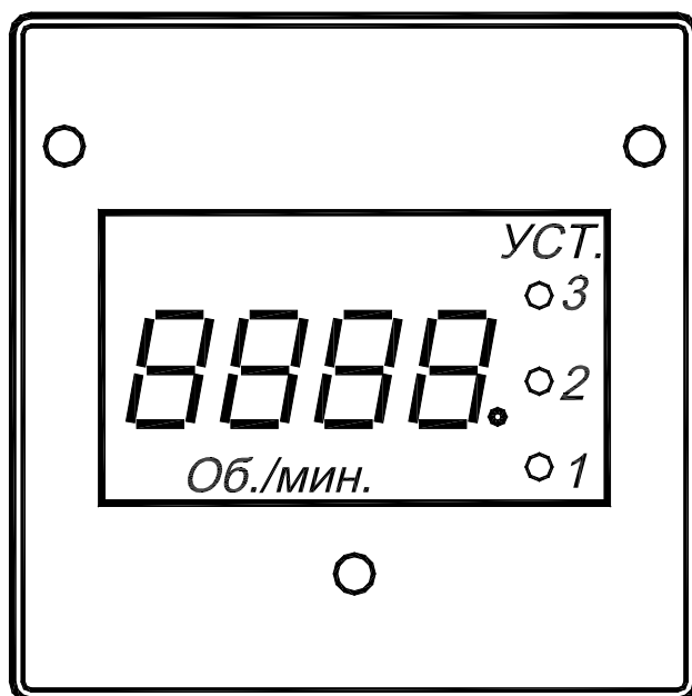
Рисунок 1 - Эскиз передней панели устройства индикации ТЭ-2
